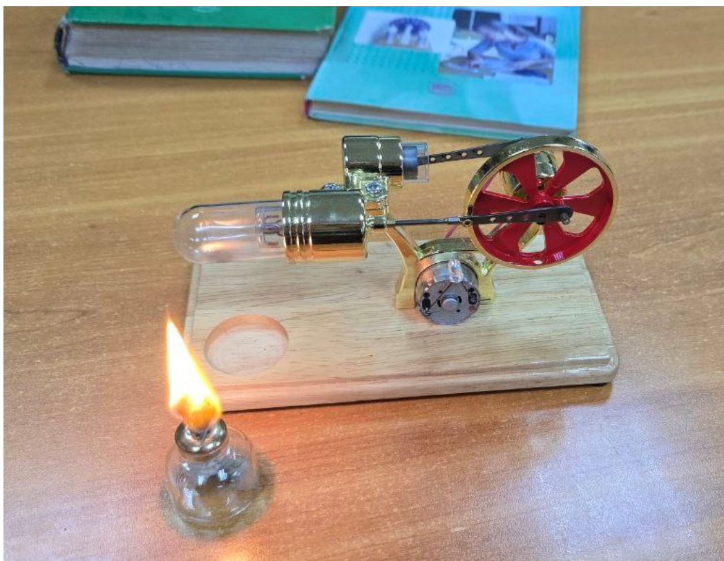
Рисунок 1. Макет двигателя Стирлинга
